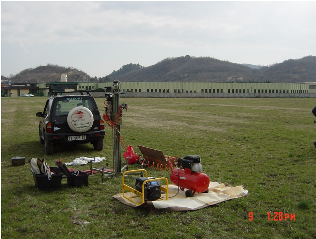
Figura 1.1: Schema dell'attrezzatura tipo per la prova Penetrometrica Dinamica Continua (D.P.).
